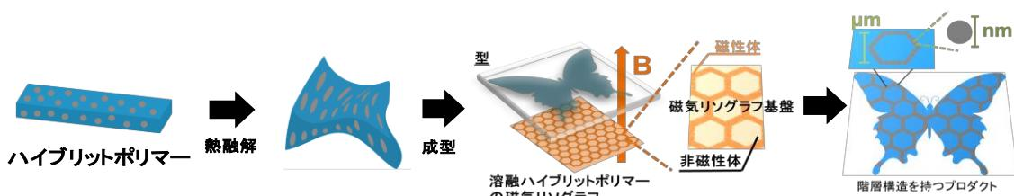
Fig.1 階層構造を有するハイブリットポリマーの作製方法
