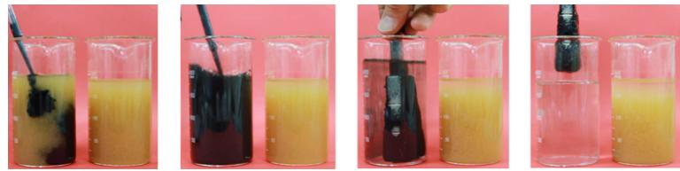
Fig. 2. MAS の磁気シーディングと磁気分離
