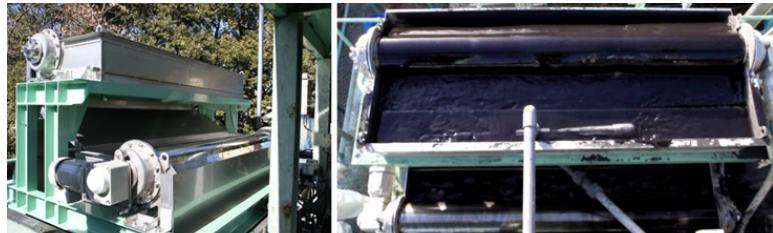
Fig. 7. MAS 用の実用大型磁気分離装置(200m<sup>3</sup>/日, 500 万円)
